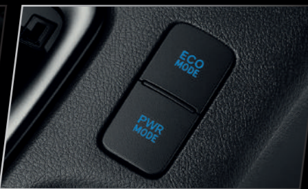
สวิตช์ปรับรูปแบบการขับขี่ เลือกได้ทั้งแบบประหยัด (ECO Mode) และแบบสมรรถนะสูง (Power Mode)
