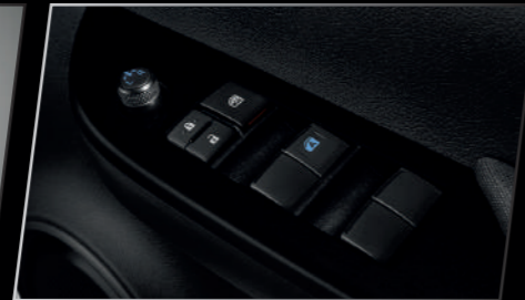
กระจกไฟฟ้า ปรับขึ้น - ลงอัตโนมัติ พร้อมระบบป้องกันการหนีบ (เฉพาะด้านคนขับ)
